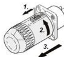
拆卸电源线
