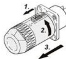
拆卸电源线
