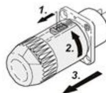
拆卸电源线
